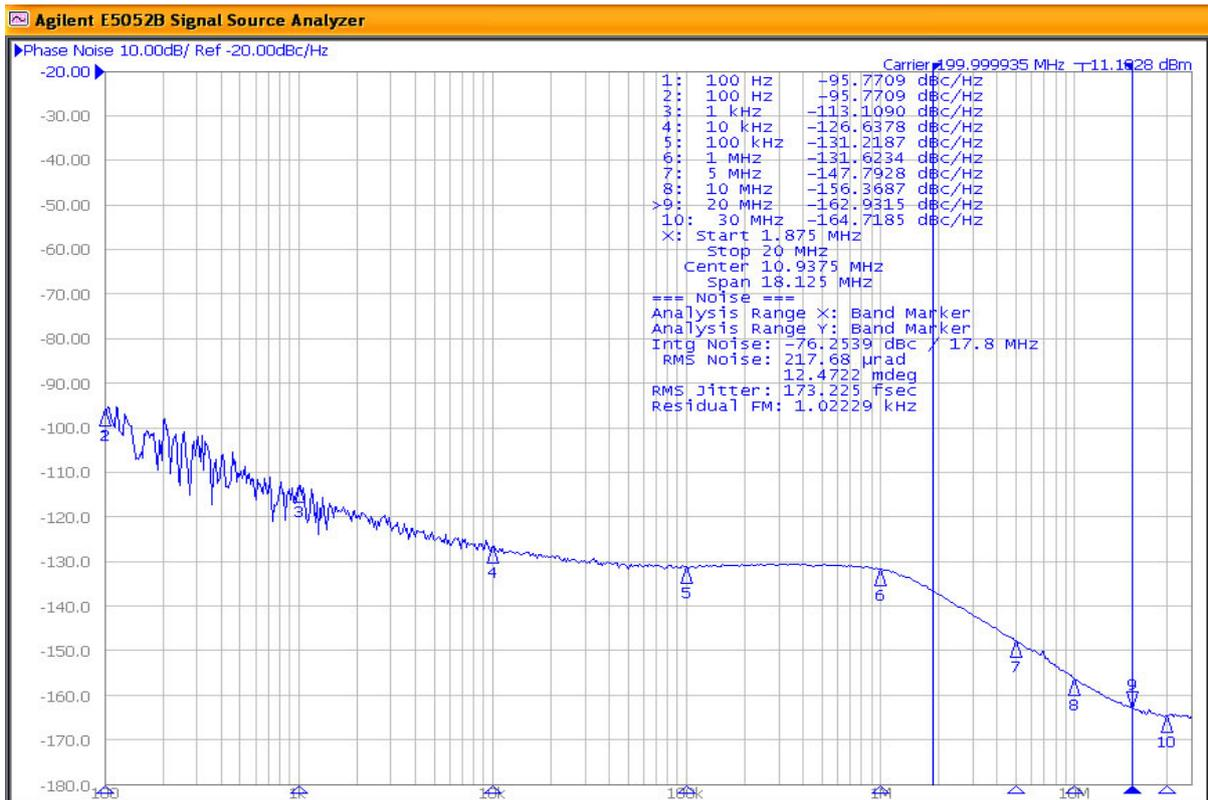
Figure 1. LVC MOS Output 200MHz 1.875MHz-20MHz 173fs
