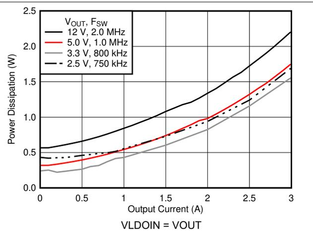
**Figure 6-14. Power Dissipation**
