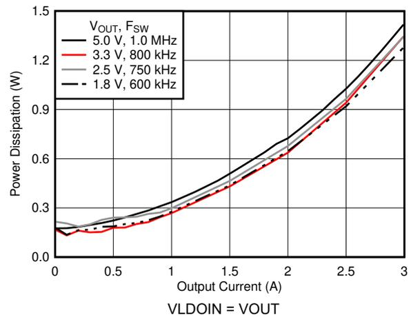
**Figure 6-8. Power Dissipation**
