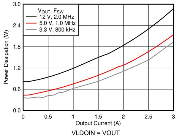
**Figure 6-20. Power Dissipation**
