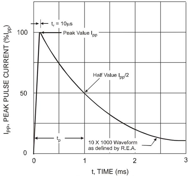
Fig. 4 Pulse Waveform
