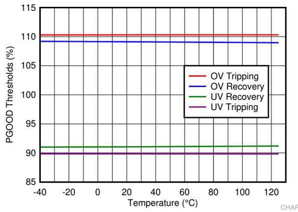
**Figure 7-9. PGOOD Thresholds**
