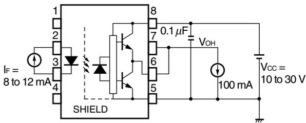
Fig. 4 V<sub>oL</sub> Test Circuit
