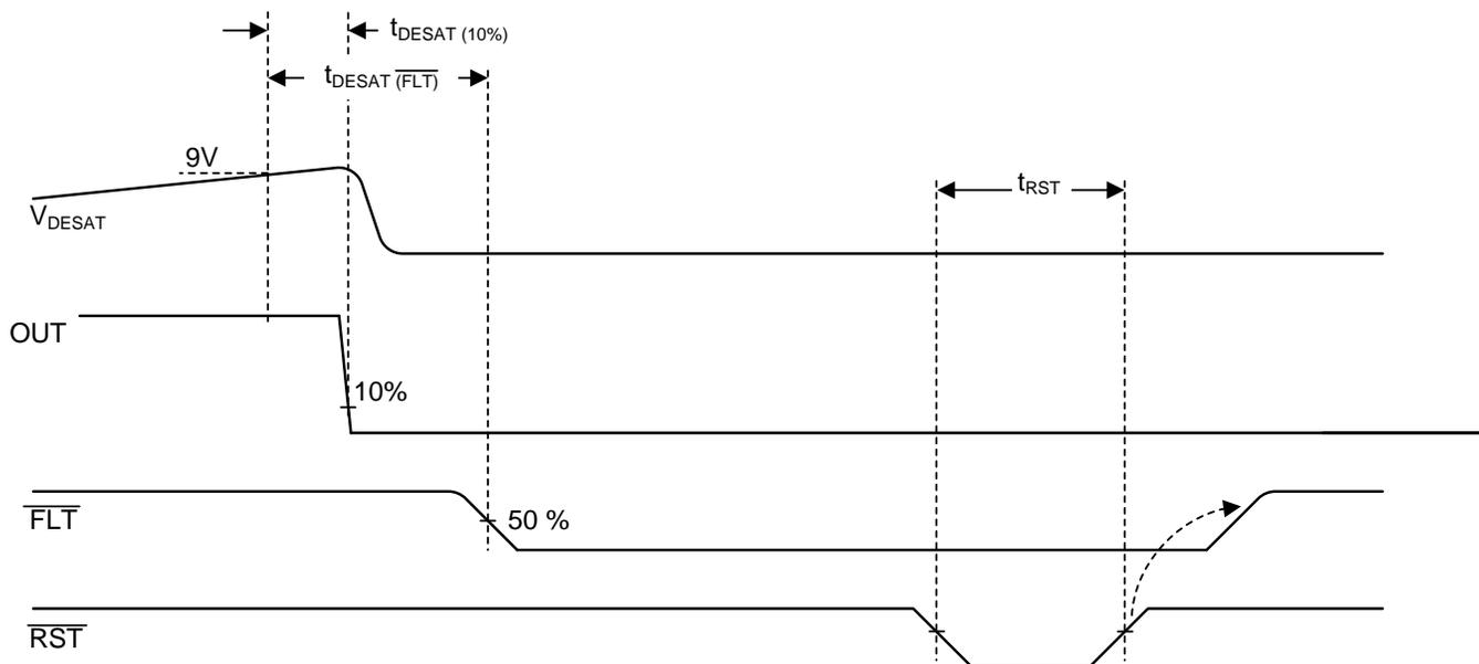
Figure 40. DESAT, OUT,  $\overline{\text{FLT}}$ ,  $\overline{\text{RST}}$  Delay
