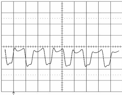
Output voltage ripple (20mV/div.) at:
