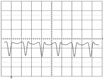
Output voltage ripple (20mV/div.) at:
