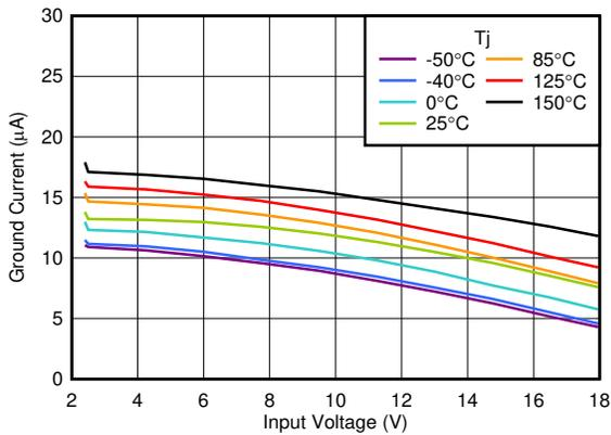
Figure 6-9.  $I_{GND}$  vs  $V_{IN}$
