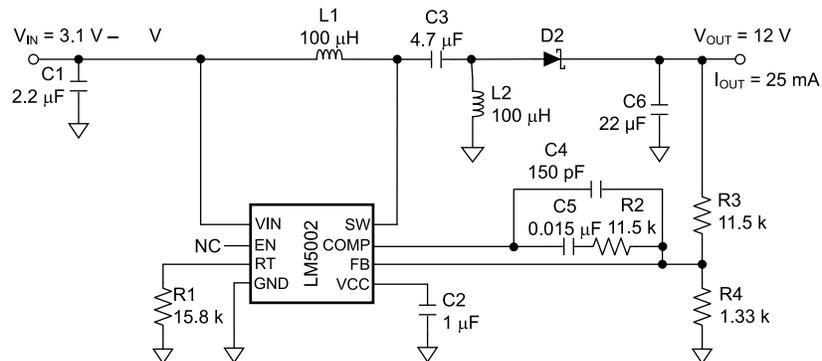
Figure 8-9. 12-V SEPIC Schematic
