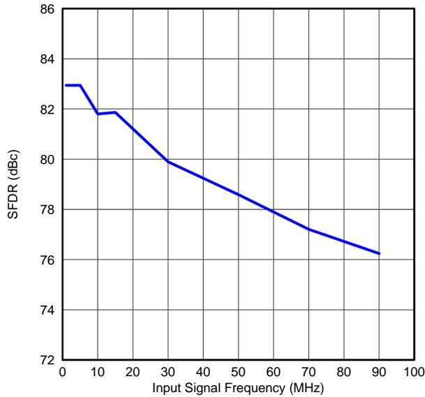
Figure 14. SPURIOUS-FREE DYNAMIC RANGE vs INPUT SIGNAL FREQUENCY
