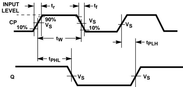
**FIGURE 1. PROPAGATION DELAY TIMES AND CLOCK PULSE WIDTH**
