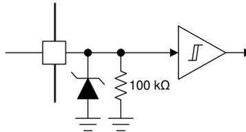
Figure 7-7. Logic-Level Input
