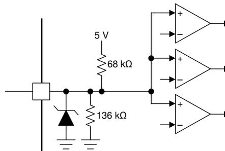
Figure 7-9. Quad-Level Input
