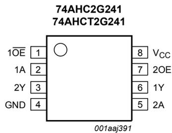
Fig. 3. Pin configuration SOT505-2 (TSSOP8) and SOT765-1 (VSSOP8)
