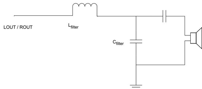
**Figure 26. SE Filter Configuration**
