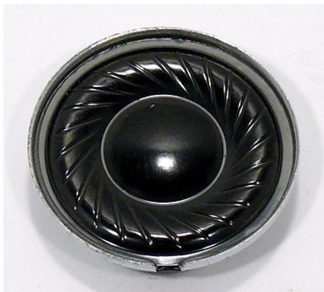
**2,3 cm (0,9") Kleinlautsprecher** mit Mylar-membran und rundem Metallkorb. Geringe Baugröße, deshalb geeignet zur Signalausgabe in Geräten, in denen wenig Platz zur Verfügung steht. Der Anschluss erfolgt über rückseitig angebrachte Lötstellen.
