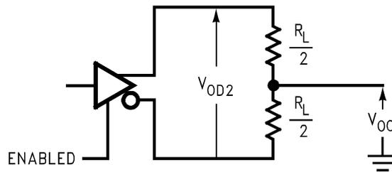
Figure 1. Driver  $V_{OD}$  and  $V_{OC}$ <sup>(1)</sup>
