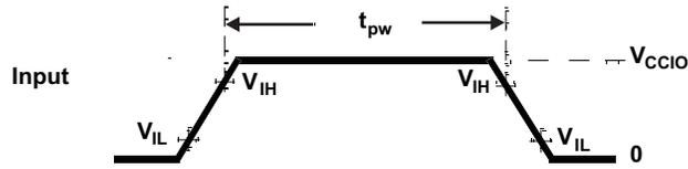
Figure 5-2. TTL-Level Inputs
