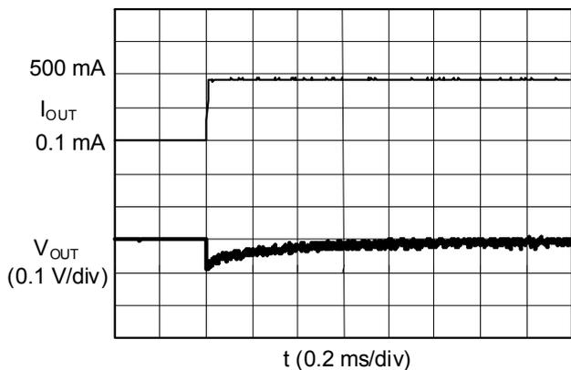
(2) S-8540A33FN ( $V_{IN}$ : 4.95 V)
