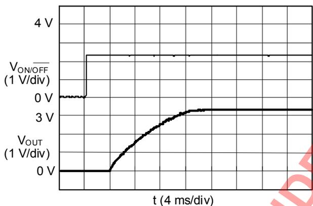
(4) S-8540C33FN ( $V_{IN} : 10 \text{ V}$ )
