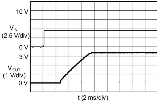
**(2) S-8540A33FN ( $V_{IN}$ : 0  $\rightarrow$  10 V)**
