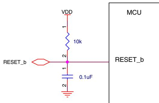
**Figure 32. Reset circuit**
