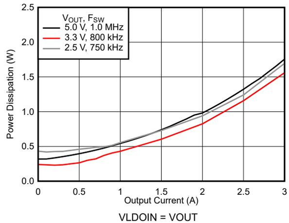
**Figure 6-14. Power Dissipation**
