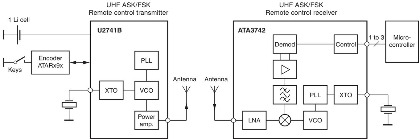
**Figure 1-2. Block Diagram**
