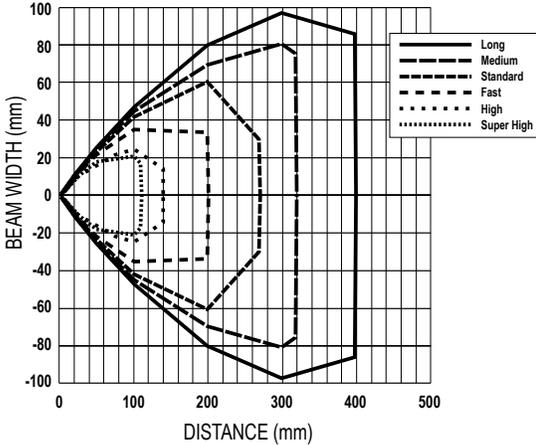
Figure 27. PBT46U-Diffuse Mode
