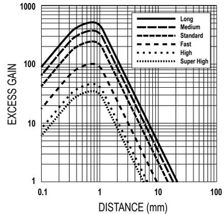
Figure 13. PBT16U-Diffuse Mode
