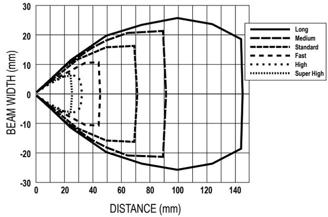
Figure 25. PBT26U-Diffuse Mode
