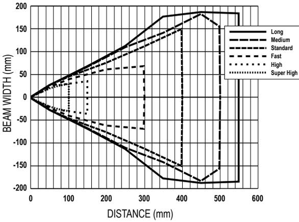
Figure 29. PBT66U-Diffuse Mode
