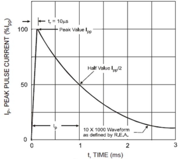
Fig. 4 Pulse Waveform
