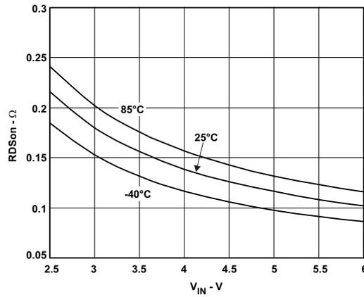
Figure 5. R<sub>DSON</sub> NMOS vs V<sub>IN</sub>
