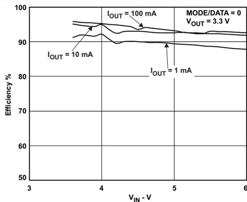
Figure 24. EFFICIENCY vs V\_IN
