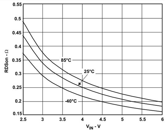
Figure 4. R<sub>DSON</sub> PMOS vs V<sub>IN</sub>
